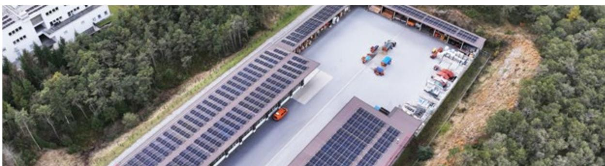
Die PV-Anlage am Dach der Straßenmeisterei Haiming umfasst 3.952 Module auf einer Fläche von über 3.500 m<sup>2</sup>.
